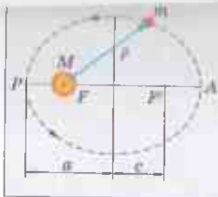
Рис. 28. Схема эллиптической орбиты движения планет: P — перигелий; A — афелий; a — среднее расстояние от планеты до Солнца; m — масса планеты; M — масса Солнца; F, F' — фокусы орбиты; r — радиус-вектор планеты; c — расстояние от центра эллипса до фокуса
