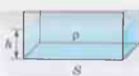
Рис. 13. Ёмкость для мысленного эксперимента по расчёту давления жидкости на дно сосуда
